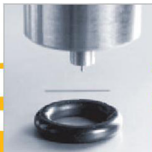
拉伸強度測試（左圖） 和合成橡膠的硬度測試
