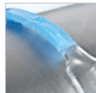
測試樣本在彎曲鋼帶的測試，符合EN ISO 22088-3標準 不含和含潤滑劑
